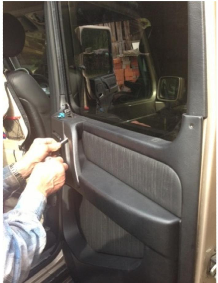
Nach lösen der beiden Schrauben des Halters an der Tür (vorne zur B-Säule), den Sprengring am vorhandenen Halter abziehen und den Splint vorsichtig ausdrücken. Schon kann man durch die Tür Innen den kurzen Türhalter
