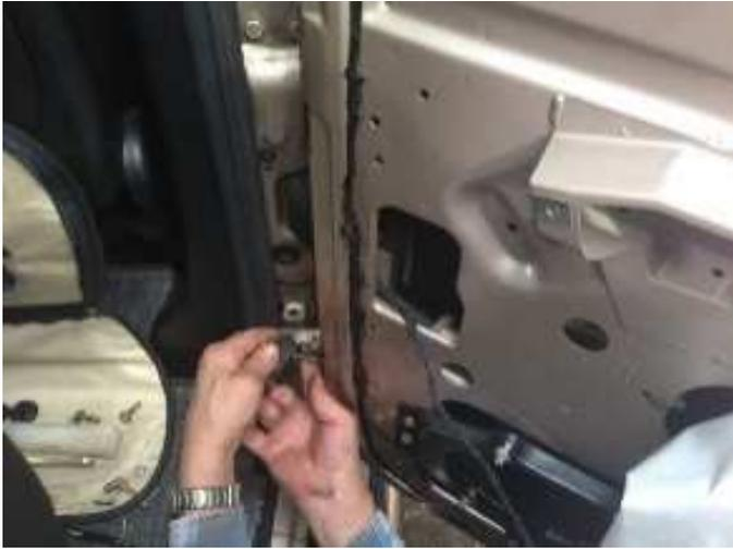
Anschließend wieder den Splint und den Sprengring an der B-Säule montieren und die Plane gegebenenfalls mit etwas neuem Kleber befestigen und die Anbauteile wieder an den Ursprungsort befestigen.
